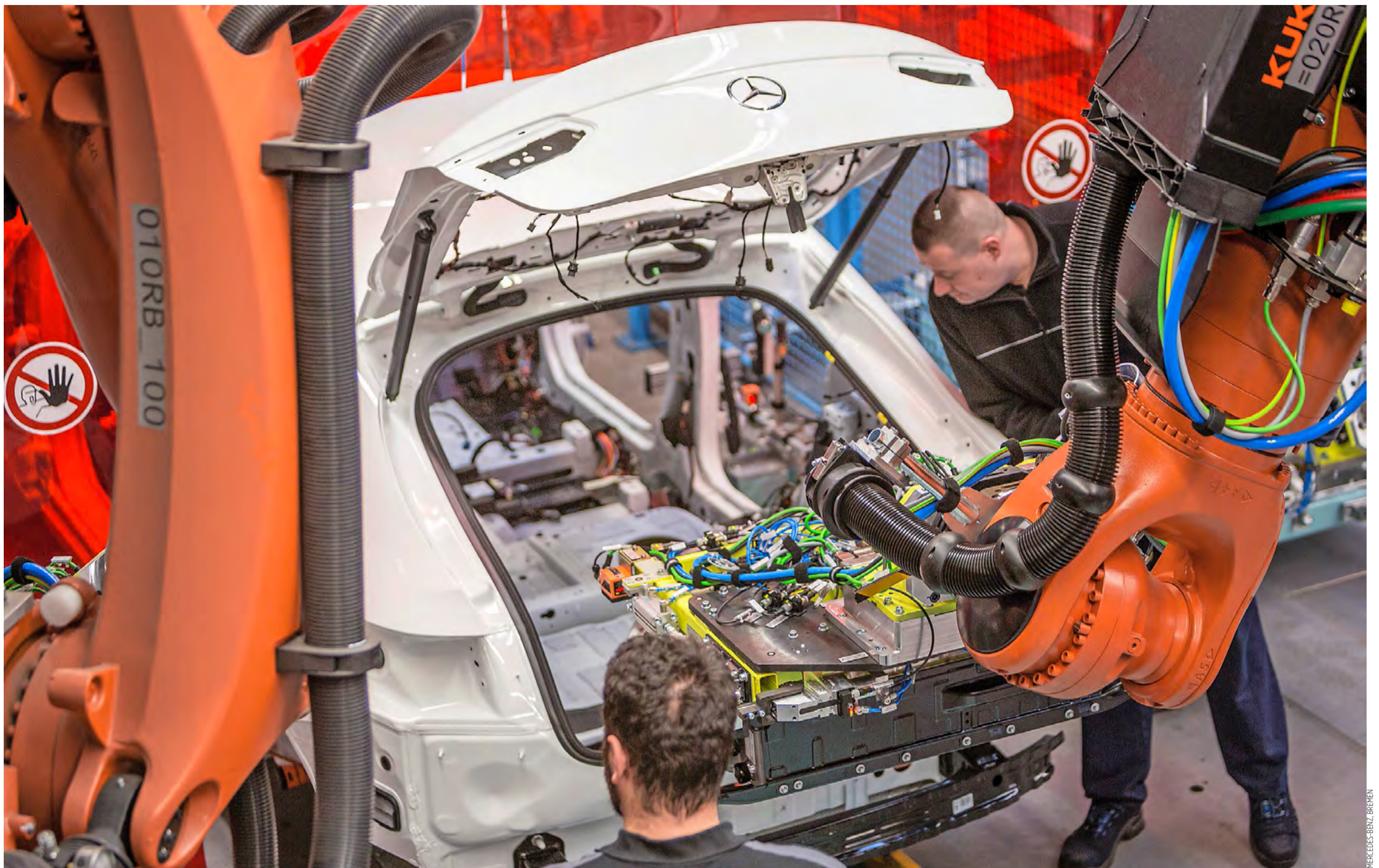
Einbau Hybridbatterie: Die neue Antriebsart wird immer wichtiger, so auch für das Volumenmodell C-Klasse. Ab 2019 soll auch der EQC, das erste reine Elektrofahrzeug von Mercedes-Benz, in Bremen gebaut werden.
